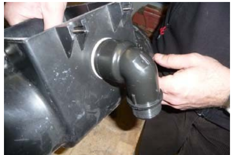
Fig. 4: Conexión lateral con el codo conectado.
